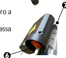
Il sistema è dotato di un dispositivo di protezione contro i corto circuiti ed i sovraccarichi elettrici; in caso di blocco, verificare le condizioni di funzionamento (stato di intasamento dei filtri, condizioni del fluido, ecc.) e provvedere al riarmo della protezione mediante il pulsante 7 posto sul fianco della scatola morsettiera.
